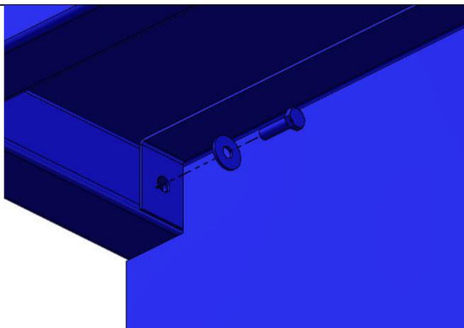
Fissare da entrambi i lati il porta cassetto al telaio con le viti e rondelle pertinenti
